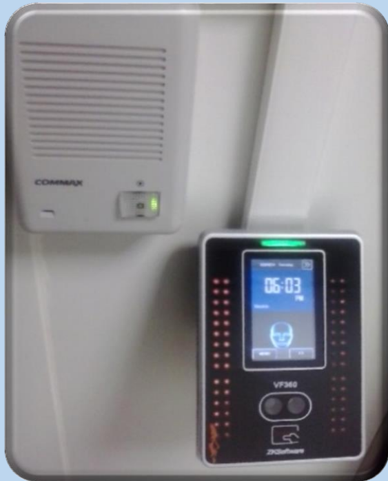
Sistemul de acces securizat controlat prin recunoastere facială, card securizat de acces, cod de acces.
